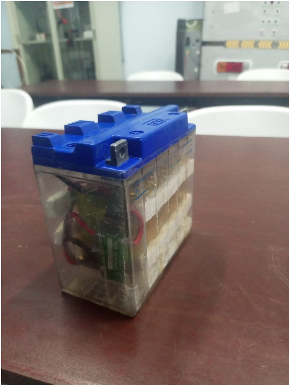
Figura 5. Vista del prototipo durante el proceso de armado.
